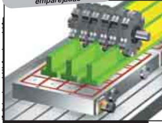
Planeado, contorneado y barrenado de particulares de acero fundido
