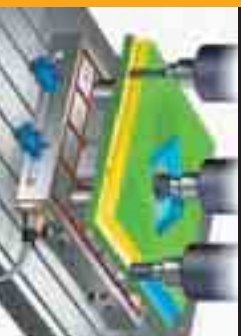
• Velco. Desbaste. Eliminación tensiones y acabado 2ª cara
